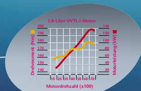
Der 1,8-l-VVTL-i-Motor des Corolla TS mit einer maximalen Leistung von 141 kW (192 PS) bei 7.800 min<sup>-1</sup> und einem maximalen Drehmoment von 180 Nm bei 6.800 min<sup>-1</sup>.
