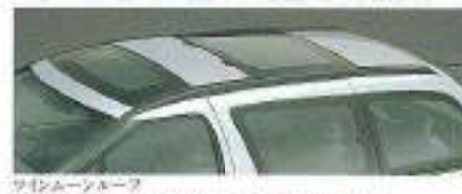
ジュエリーサンルーフ キャビンに自然光をもたらす高い天井の内部にサンルーフを設置。フロントサンルーフはパワースライド式、リヤサンルーフは電動リクライニング式です。
