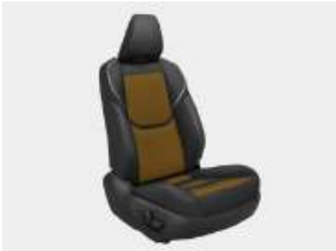
■写真はZ (2WD)。オレンジは、ヒーター加温箇所
