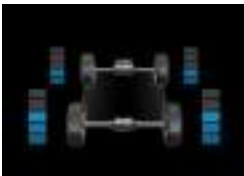
マルチインフォメーションディスプレイ内の前後輪トルク配分量表示
