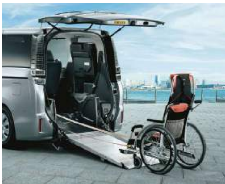
Photo:X(2WD) 車いす仕様車(タイプI)“車いす1脚仕様”。 ボディカラーはシルバーメタリック(1F7)。 電動スロープと電動ウインチ※はセットでメーカーオプション。専用車いすは販売店装着オプション。 ※電動ウインチは単独での選択が可能です。 ●写真は合成です。
