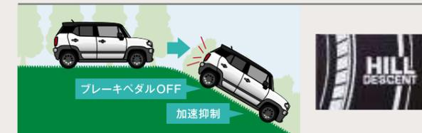
ブレーキ操作をしなくても自動的に車速を約7km/hにコント
