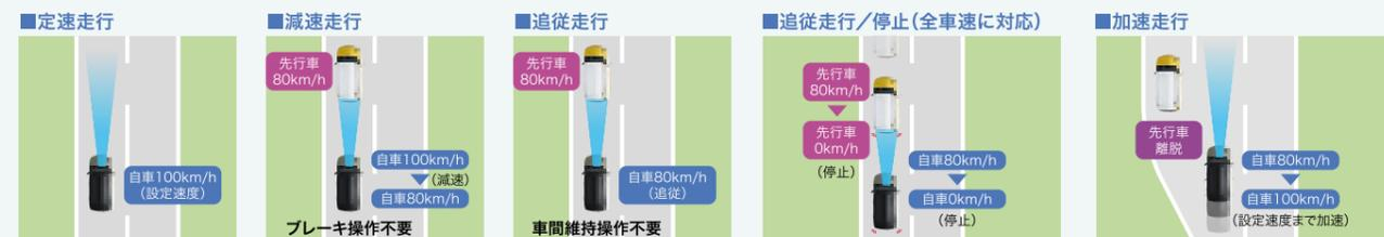
●追従走行は、約40km/h未満でも作動し、停止まで継続します。●追従走行中の先行車が停止すると自車も停止し、その後約2秒でブレーキは解除されます。停止を続ける場合は、必ずブレーキペダルを踏んでください。●道路状況および天候状況等によっては、ご使用にならない場合があります。また、ACCの制御には限界があります。装置を過信せず、常に安全運転に努めてください。\*イラストは高速道路や自動車専用道路での走行例です。
