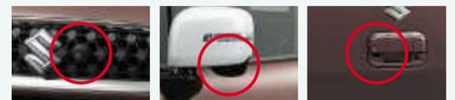
●フロントカメラ ●サイドカメラ(左右) ●バックカメラ
