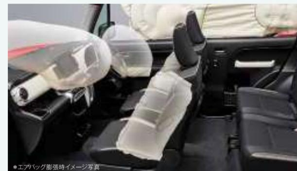
\*SRSエアバッグシステムは、シートベルトを補助する装置ですので、必ずシートベルトを着用してください。●SRSエアバッグシステムは、衝突の条件によっては作動しない場合があります。また、ご注意ください。項目がありますので、必ず取扱説明書をよくお読みください。SRSカーテンエアバッグ、フロントシートSRSサイドエアバッグは、実際の衝突時には衝突側のみ膨らみます。\*SRS=Supplemental Restraint System(補助拘束装置)
