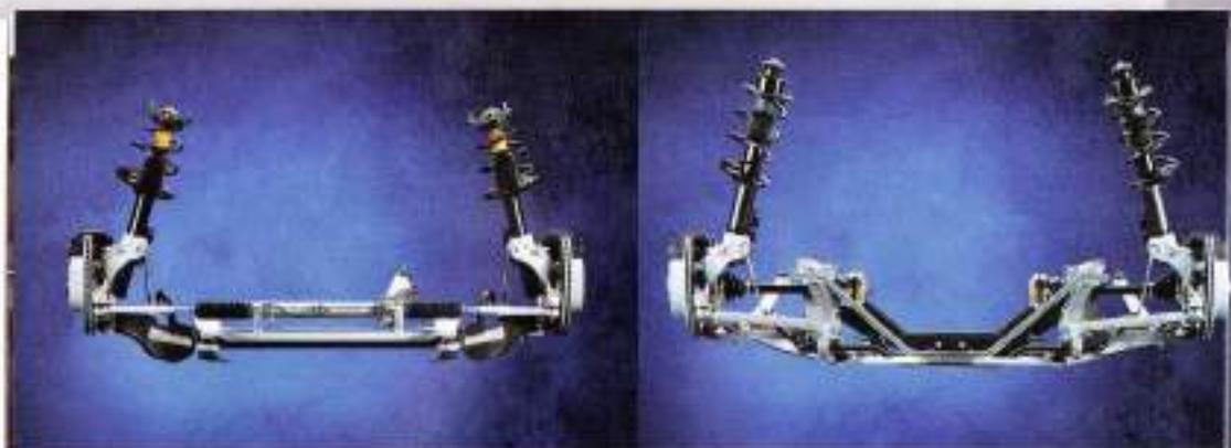
Essai McPherson avec bras de suspension et jambe de force sur le Boxster.
