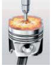
**Die Voreinspritzung** führt zu einer „weichen“ Verbrennung und damit zu einer ausgezeichneten Verbrennungsakustik und einem angenehmen Motorlauf.
