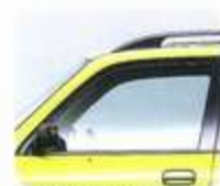
UVカットガラス(全車) 前席には日焼けの原因となる紫外線や熱線を吸収するUVカットガラスを採用しました。
