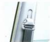
フロントシートベルトショルダージャスター(全車) シートベルトの取り付け高さを調節。どんな体格でも適切な位置でベルトが装着できます。
