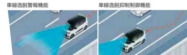
約60km/h以上で走行中にステレオカメラが区画線を検知している場合、道路上の車線から逸脱しそうになると、ブザーとメーター内表示でお知らせするとともに、車線内に戻すようステアリング操作をアシストします。
