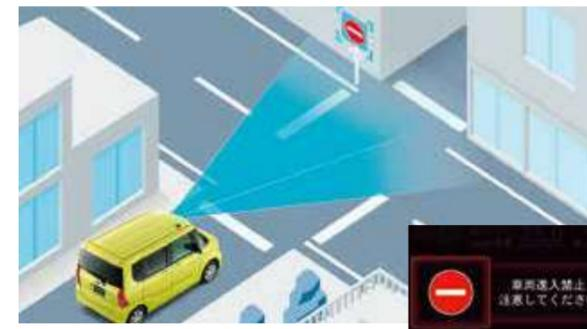
■次のような場合は、適切に作動しないことがあります。●標識の手前で減速した時や、右折または左折しようとしている時●標識が高速道路の分岐した直後、または合流直前の隣の車線にある時●車両進入禁止標識の色、形に似たものが周辺にある場合(類似の標識、電光掲示板、看板、のぼり旗、構造物など)●ロータリー(環状交差点)を走行している時●悪天候時(豪雨、吹雪、濃霧、砂嵐など)●夕方、朝方の薄暗い時や、夜間に対象物に接近する時●屋内の駐車場など暗い場所に対象物に接近する時●前方から強い光(太陽光などによる逆光や対向車のヘッドランプの光など)を受けた時●標識の全体または一部が、木・電柱などで隠れている時●標識が泥、雪、または霜などで覆われた時●標識が街灯などの光や建物の影などで見えにくくなっている時など■このほか標識認識機能についての詳細は取扱説明書をご覧ください。
