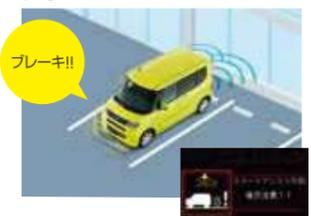
後方約2～約3m先までに壁などの障害物等があることをソナーセンサーが検知している時に、シフトポジションを[R]にしたままブレーキペダルと間違えるなどして必要以上にアクセルペダルを踏み込んだ場合、急発進を抑制します。
