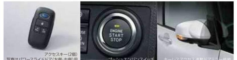
キーレスアクセス&プッシュスタート[タッチ式リクエストスイッチ付(運転席・助手席)/リクエストスイッチ付(リヤゲート)]電動格納式カラードドアミラー(キーレスアクセス連動)
