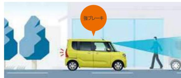
1次ブレーキが作動している時にドライバーがブレーキペダルを踏み込むと、ブレーキアシストが作動し、ブレーキ制動力を高めます。衝突が避けられないとシステムが判断した場合、強いブレーキで減速。衝突の回避や、被害の軽減をサポートします。
