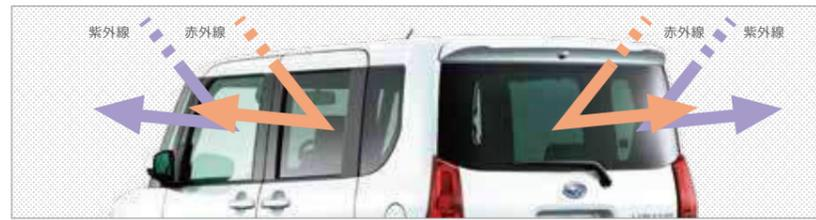
360° スーパーUV&IRカット機能付ガラス(フロントクォーター/フロントドア/リアドア/リヤクォーター/リヤゲート)
