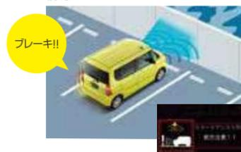
前方に障害物等があることをステレオカメラ(約4m以内)またはソナーセンサー(約2～約3m以内)が検知している時に、シフトポジションを[D]、[B]、[S]にしたままブレーキペダルと間違えるなどして必要以上にアクセルペダルを踏み込んだ場合、急発進を抑制します。
