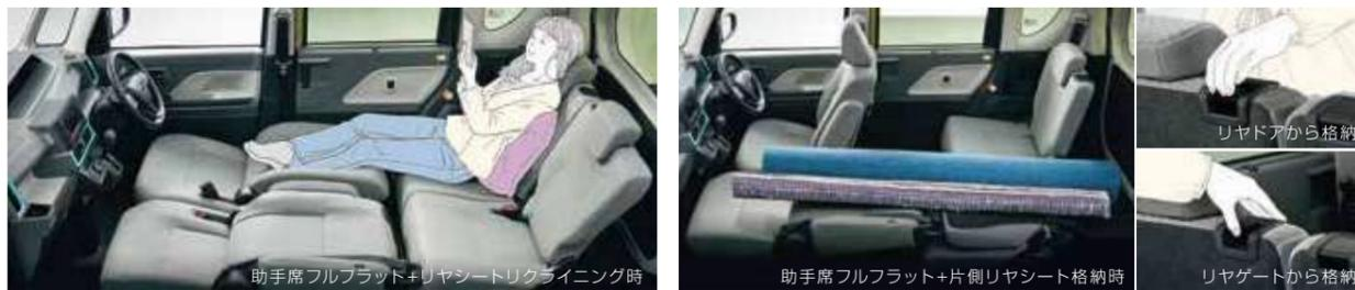
助手席フルフラット機構／分割可倒式リクライニングリヤシート(ワンモーション格納機構付)
