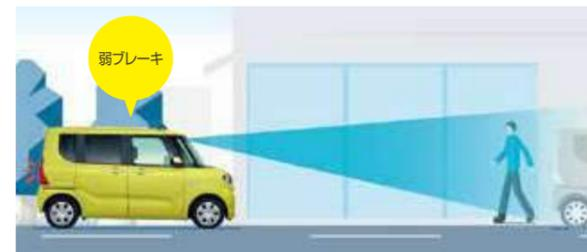
走行中に前方の車両や歩行者をステレオカメラが検知し、衝突の危険性があると判断した場合、ブザー音とメーター内表示で警告します。衝突の危険性がさらに高まったとシステムが判断した場合、弱いブレーキをかけます。
